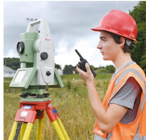
▲ Aux commandes du tachéomètre, Bastien Gay communique avec son collègue installé non loin de là à côté de la canne à prisme.
