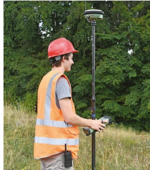
**> Mesures par satellites** Les mesures peuvent aussi être prises à l'aide de récepteurs de signaux transmis par satellites. Les géomaticiens se servent de plus en plus souvent de drones, surtout pour des photos aériennes.
